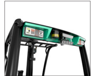
Feux de travail à LED, deux à l'avant et un à l'arrière
